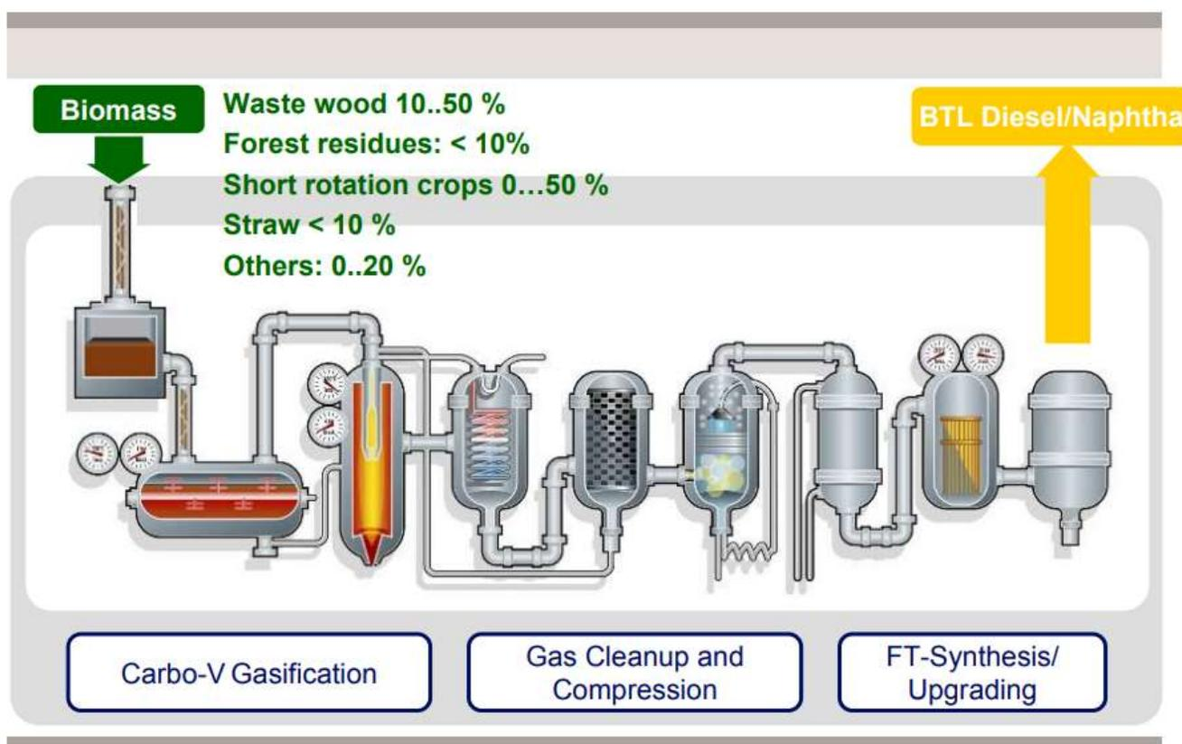
Figure 33. Choren Carbo-V® Process sketch<sup>[31]</sup>
